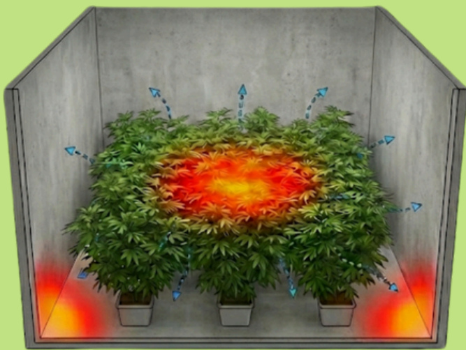
Unzureichende Luftbewegung führt zu lokalem Wärme- oder Feuchtigkeitsstau. Die Folgen sind Mikroklimata und heterogene Zonen im Raum. Sensorwerte sind nicht repräsentativ und der Bestand gefährdet.
