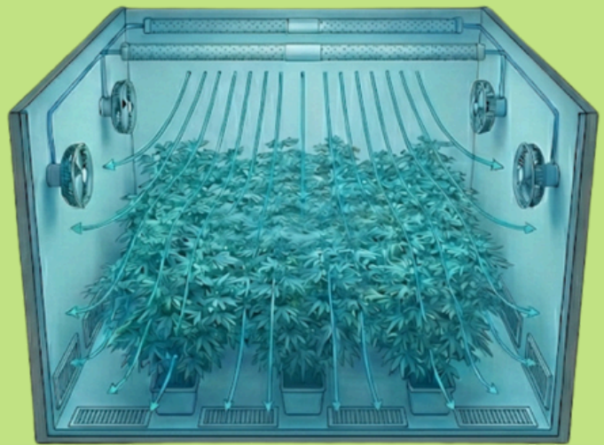
Aktive und gezielte Luftzirkulation schafft einen sanften, gleichmäßigen Luftstrom durch das Blätterdach und den Raum. Temperatur, Feuchtigkeit und CO 2 werden so konstant gehalten und optimales Wachstum garantiert.
